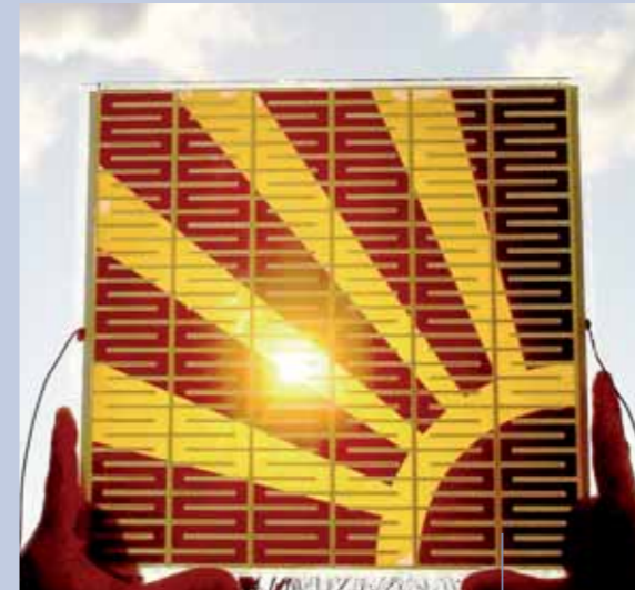
◀ Dieses Farbstoff-Solarmodul nutzt den Photoeffekt, um mithilfe des Sonnenlichts elektrischen Strom zu erzeugen. (Bild: Fraunhofer-Institut für Solare Energiesysteme ISE)
