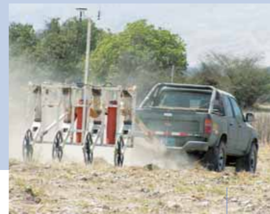
▼ Hier nutzen Forscher eine an einen Pick-Up angehängte SQUID-Apparatur, um eine archäologische Ausgrabungsfläche magnetisch zu kartieren. Noch vor dem ersten Spatenstich kann das Messsystem selbst feinste, durch die Hinterlassenschaften alter Kulturen verursachte Veränderungen der magnetischen Eigenschaften des Bodens aufspüren. (Bild: IPHT Jena, Abteilung Quantendetektion)
